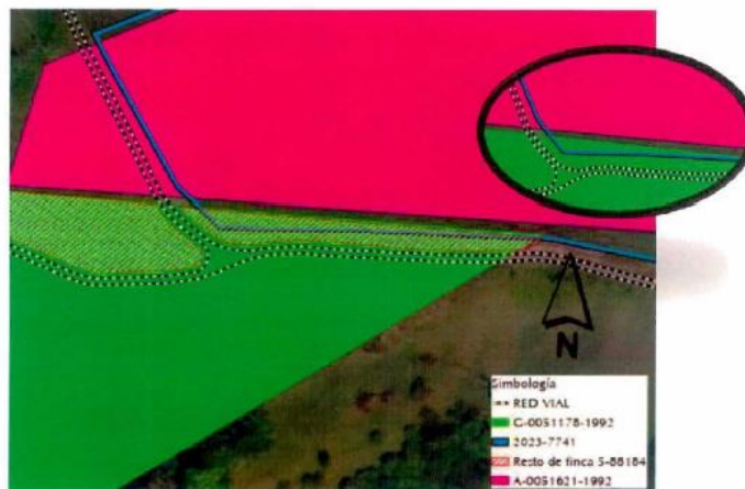
Figura N°09. Montaje del plano de agrimensura con citas 2023-7741 y los planos catastrados C-0051178-1992 y A-0051621-1992.
